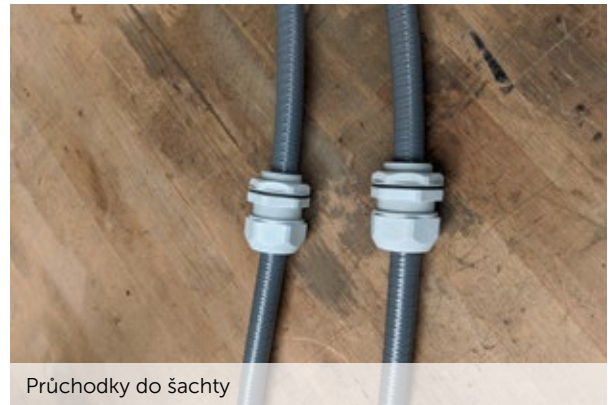
Vývod spínací hadice z tělesa protiproudu přes redukcí do ochranné hadice
